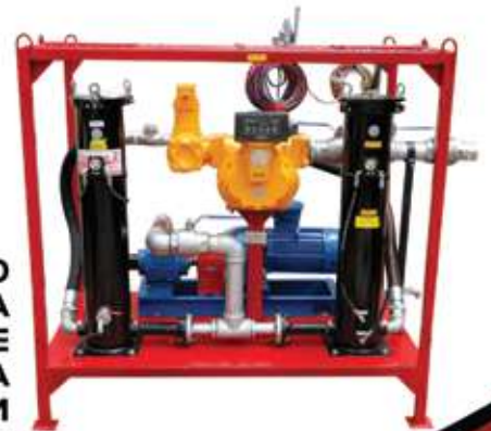
EQUIPO DE ALTO CAUDAL PARA TRASEGAR COMBUSTIBLE DESDE BARCAZA 265 GPM
