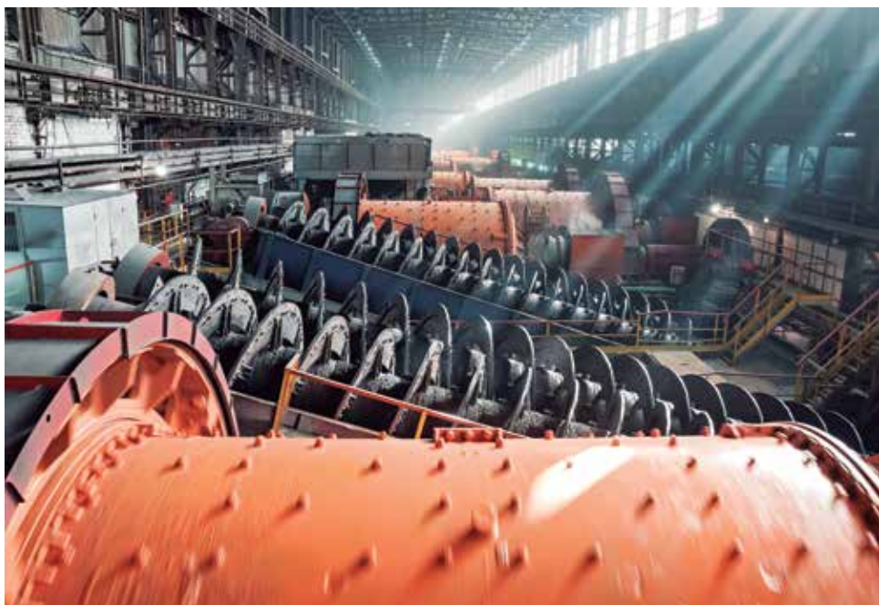
El proceso de molienda reduce las partículas a través del uso de grandes aparatos giratorios o molinos de forma cilíndrica.
